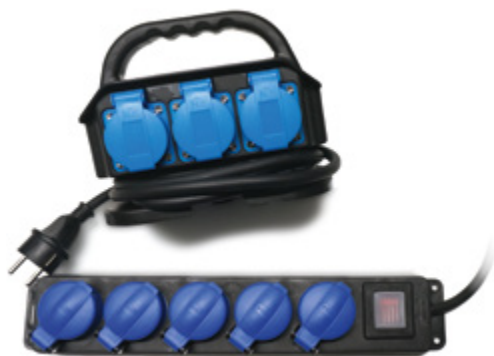
Folgende Kriterien sind relevant: Schutzart mind. IP44, robuste Anschlussleitung (z. B. H07RN-F), stabiles Gehäuse (z. B. schlagfester Kunststoff oder Aluminium)
